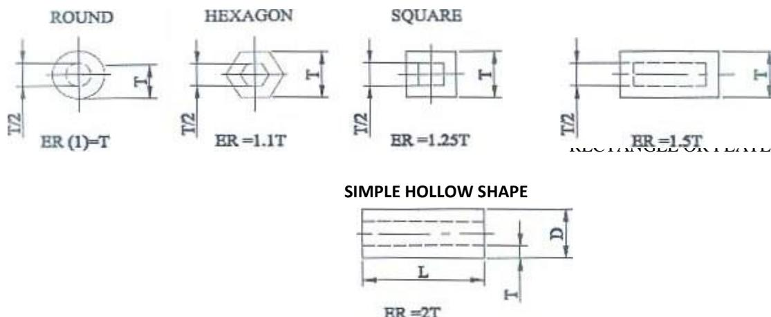
**a) SIMPLE GEOMETRIC EQUIVALENT ROUND SECTIONS/SHAPESHAVING LENGTH L**
