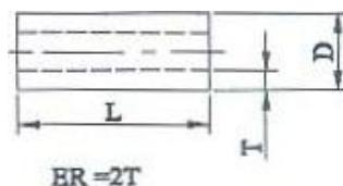
**a) SIMPLE GEOMETRIC EQUIVALENT ROUND SECTIONS/SHAPESHAVING LENGTH L**
